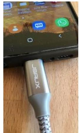
Die neueren Smartphones (Google/Apple) unterstützen OTG (On-The-Go); Diese OTG-Adapterkabel oder OTG-USB-Speicher werden direkt an das Smartphone angeschlossen.
